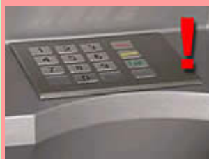
Klawiatura z założoną nakładką
